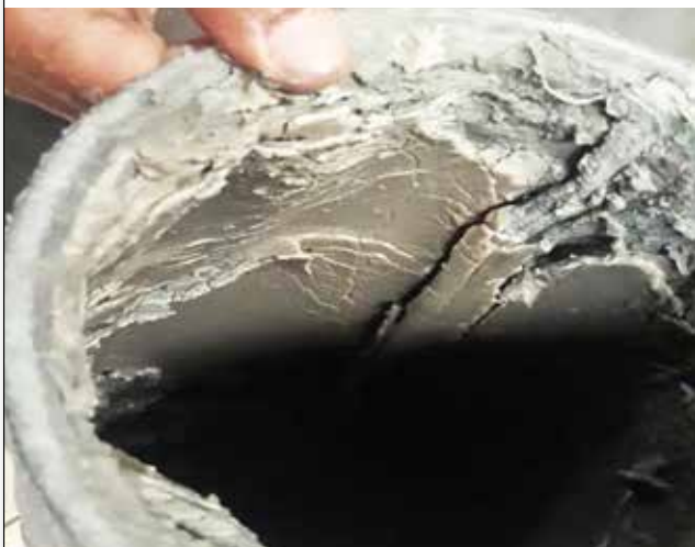
Sin Vulcan, el filtro se atascaba rápidamente por depósitos calcáreos y tenía que cambiarse cada 48 horas.
